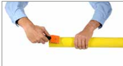
5. Rasar la zona de soldadura del tubo.
